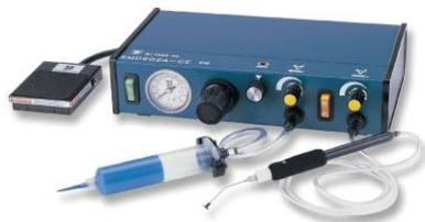
Модель предназначена для сборки и дозировки при работе с миниатюрными элементами. Манипулятор «карандаш» идеально подходит для поверхностного монтажа и работ по сборке либо переделке на уровне отдельных микросхем. Точное нанесение тонкого слоя паяльной пасты и других материалов становится возможным до размещения элементов при помощи манипулятора. Данная модель применяется во многих областях промышленной сборки, предусматривающих работу с миниатюрными элементами.
