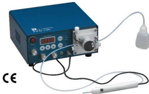
Дозаторы на базе шланговых насосов передают жидкости малой вязкости за счет давления нагнетания, создаваемого вращающимся ротором в шланге, переносящем материал. Обычно эти насосы используют с жидкостями, которые являются опасными или сложными в работе, для которых рекомендуется ограничить вероятность контакта оператора с жидкостью. Другой причиной является то, что в шланговых насосах не используется воздух.
