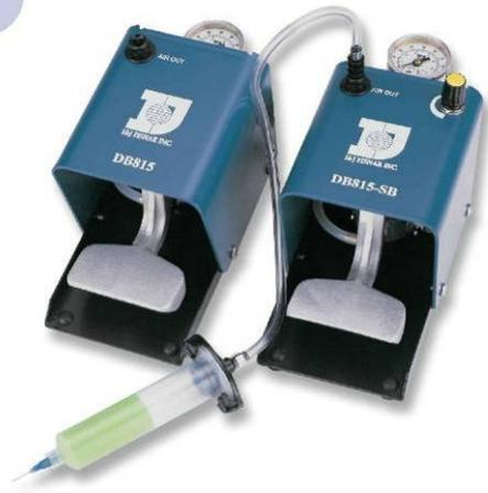
Базовая система, приводимая в действие сжатым воздухом, монтируемая на полу и управляемая посредством напольной педали. Модель снабжена трехходовым воздушным клапаном и встроенным регулятором воздушного потока, идеально подходит для дозировочных работ, где нет жестких требований точности. Поступление жидкости происходит постоянно, пока педаль удерживается в нажатом состоянии.
