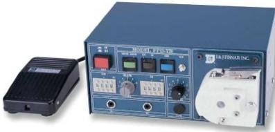
Устройство аналогично модели PPD-119, но снабжено более быстрым ротором и возможностью задавать интервал дозировки от 0,01 сек. Модель совместима с требованиями к чистым комнатам и обеспечивает обратное всасывание для предотвращения утечек материалов между циклами. Система предназначена для использования только с материалами малой вязкости, такими как цианакрилатный клей, УФ-отверждаемый клей, масла и растворители.
