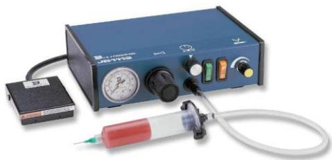
Экономичная и популярная модель дозатора общего назначения, удобная в эксплуатации, при которой требуется лишь несколько простых действий – подсоединить насадку емкости (входит в комплект) – подключить подачу воздуха и питания – установить таймер – заполнить емкость материалом – установить регулятор подачи воздуха – нажать напольный переключатель и начать дозировку.
