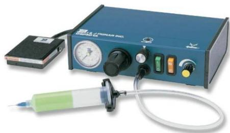
Модель снабжена более крупным внутренним воздушным клапаном, рекомендуется для действий, при которых требуется немедленная и быстрая реакция на сброс давления. Примеры: работа с гибкими тубами, уплотнение швов, работы с блочными емкостями и поворотным столом. Выход, рассчитанный на повышенный объем, предотвращает посткомпрессию материалов в тубах и возможность неравномерного их распределения.
